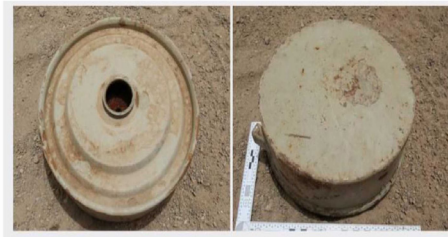
الملك 23 و24: لفجر مضاد للبركات مصنع من طرف الحوثيين (اليسار واليمين)، انكر في صنعه بشكل طفيف على تصميم لفر مضاد للبركات من نوع TM-46 أو TM-57. لفر مضاد للبركات صيدلية تابع لمؤسسة «أبحاث التسليح آله الصراعات» في المخايلين، يوليو 2018.
