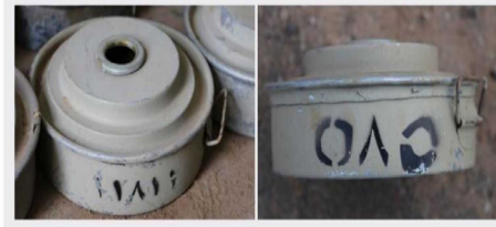
الملك 23 و24: لفجر مضاد للبركات مصنع من طرف الحوثيين (اليسار واليمين)، انكر في صنعه بشكل طفيف على تصميم لفر مضاد للبركات من نوع TM-46 أو TM-57. لفر مضاد للبركات صيدلية تابع لمؤسسة «أبحاث التسليح آله الصراعات» في المخايلين، يوليو 2018.
